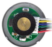
شکل 5 - شفت انکودر با عملکرد سیستم اثر هال
