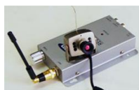
شکل ۷. دوربین بی سیم استفاده شده در ربات امدادگر
